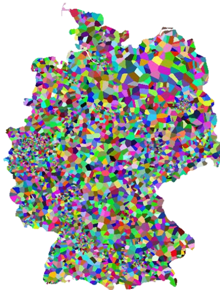
Abbildung 4: Voronoi-Gebiete für jeden Knoten des Hochspannungsnetzmodells
